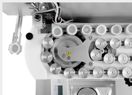
将样品放入自动进样器并进行分析
